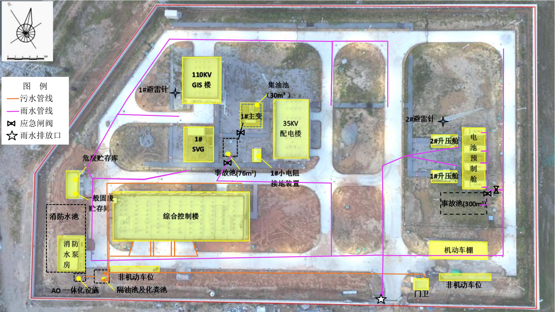
附图 06 项目升压站雨污管网图
